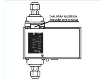
Figura 1 – Ajustes do Pressostato
